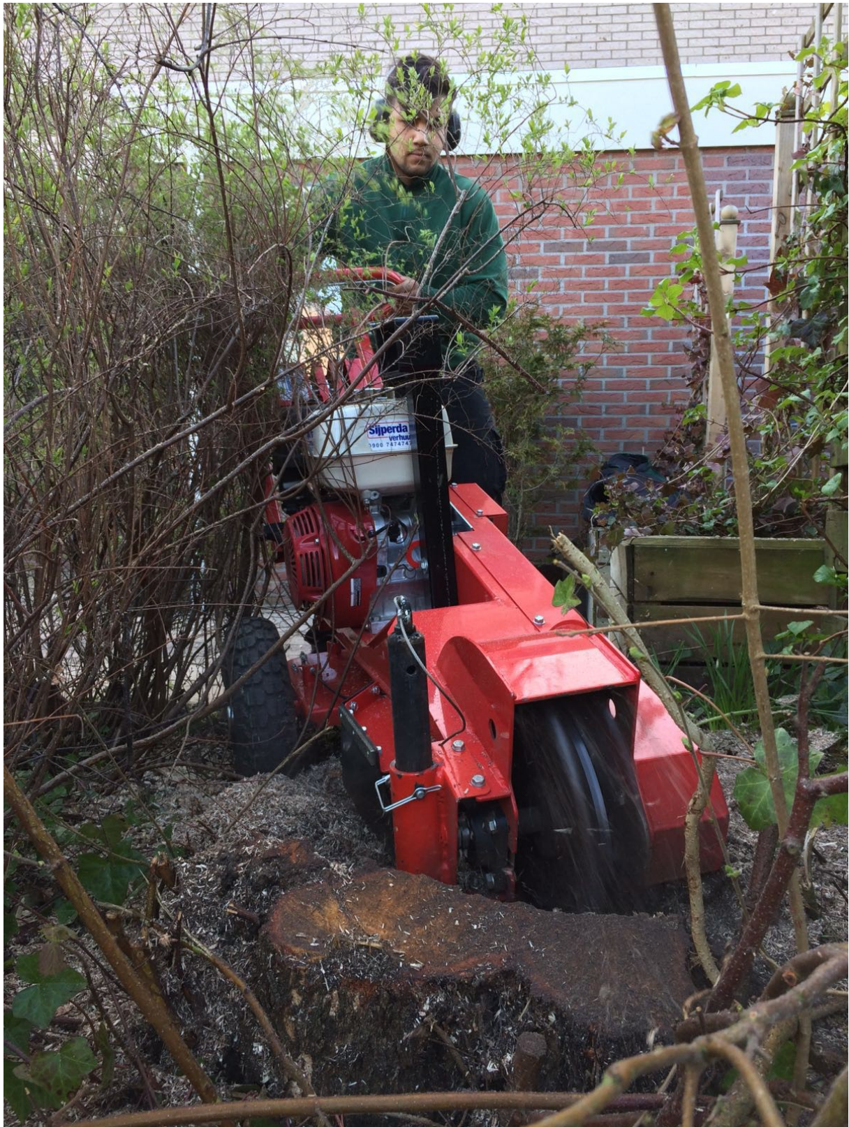
Met de stobbenfrees machine verwijderen we een boomstronk, waardoor er direct ruimte ontstaat voor nieuwe aanplant in de border.
